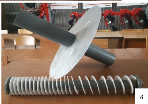
Рисунок 7 – СВЧ-воскотопка: а – общий вид; б – пускозащитная аппаратура; в – фторопластовый нагнетательный шнек, кожух и кольцевой диск; 1 – магнетроны с волноводами; 2 – полусферические резонаторы; 3 – приемная емкость; 4 – нагнетательный шнек в корпусе; 5 – вентилятор для охлаждения магнетронов; 6 – мотор-редуктор (100YT200WGV22B); 7 – преобразователь частоты (Wanshsin 0,2 кВт); 8 – выгрузное окно; 9 – шкаф управления; 10 – УЗО; 11 – автоматический выключатель, соответственно: мотор-редуктора, магнетронов 1-го и 2-го резонаторов; 12 – магнитные пускатели; 13 – высоковольтные трансформаторы 220 В/4,5 кВ
