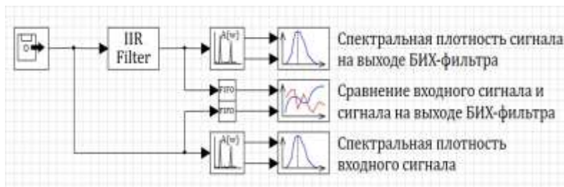
Рисунок 3 – Виртуальная модель процесса режекции узкополосной помехи* * составлено авторами на основании исследования
