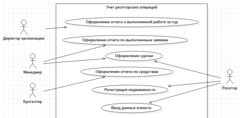
Рисунок 2 – Диаграммы вариантов использования разрабатываемой системы
