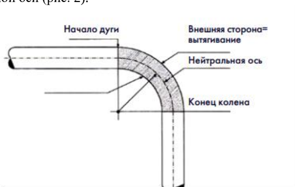
Рисунок 2 – Изменение формы трубы в результатегиба
