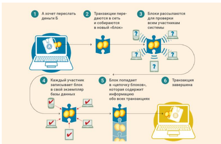
Рисунок 1 – Как работает блокчейн
