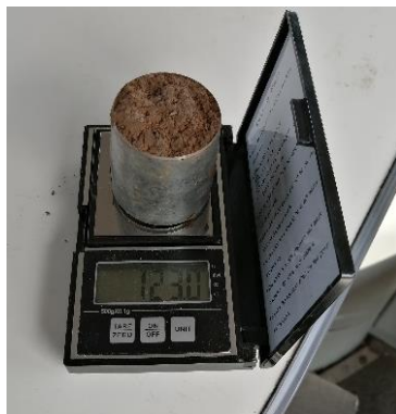
Рисунок 1 – Процедура определения показателей пенетрометра и массы пробы грунта
