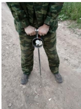
Рисунок 1 – Процедура определения показателей пенетрометра и массы пробы грунта
