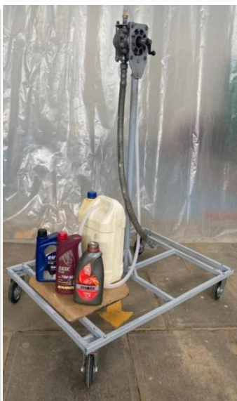
Рисунок 4 – Схема (а) и общий вид (б) установки для подачи трансмиссионного или моторного масла: 1 – насос НШ-32; 2 – рукоятка; 3, 4 – подающий и всасывающий рукава с наконечниками; 5 – стойка; 6 – ёмкость 10 л с трансмиссионным или моторным маслом; 7 – ёмкость 20 л со срезанным верхом; 8 – рама с опорными колёсами
