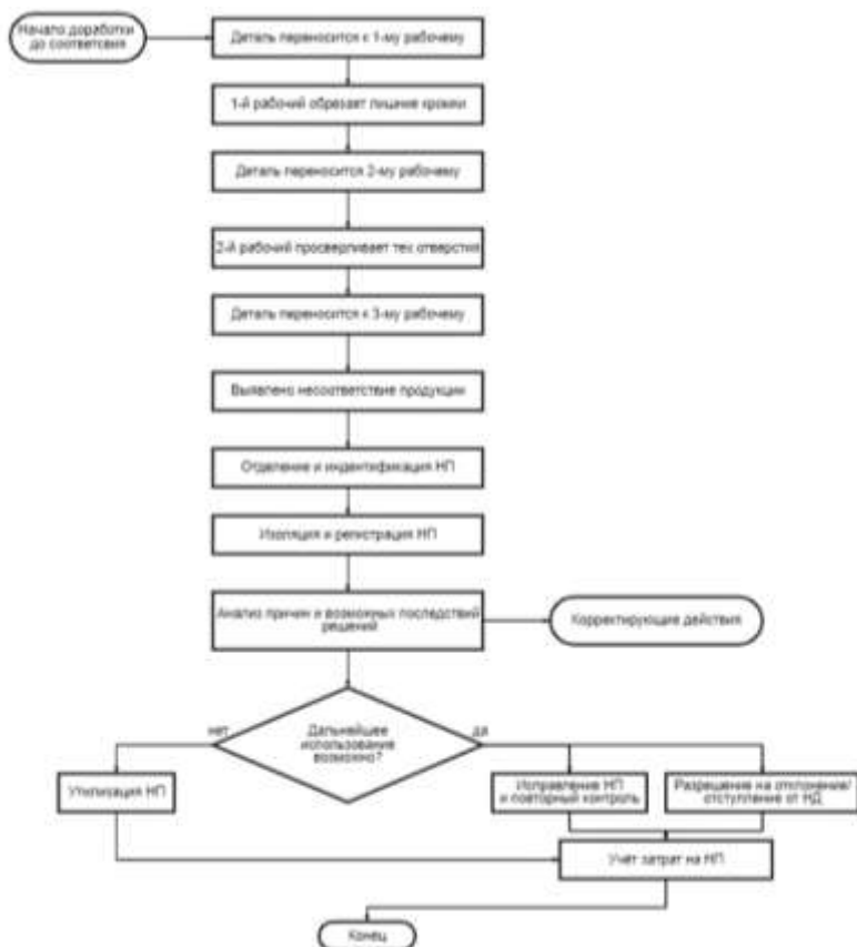
Рисунок 1 – Блок-схема до внедрения Lean системы *составлено автором
