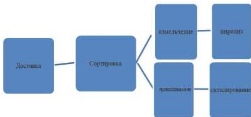
Рисунок 2 – Выбранная схема технологии переработки ТБО на мусоросортировочном предприятии*
