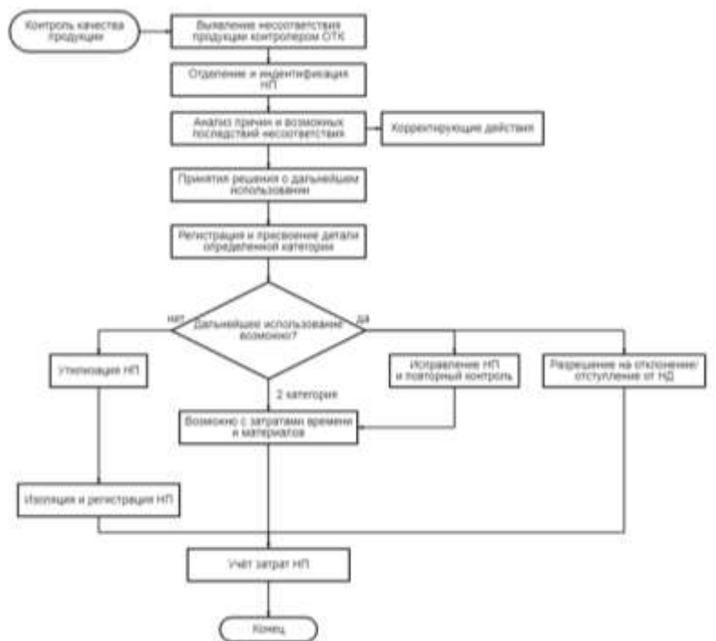
Рисунок 2 – Блок-схема после внедрения Lean системы *составлено автором
