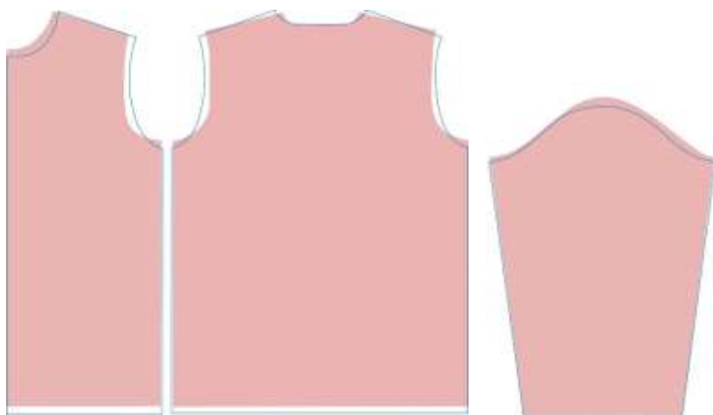
Рисунок 1 – Сравнение конструкций деталей женской и мужской сорочки на основе плоского кроя: мужчины – голубой контур, женщины – розовый
