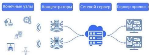
Рисунок 4 – Принцип работы сети LoRa
