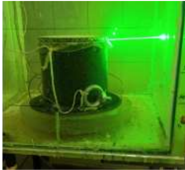
Рисунок 2 – Разрушение диафрагмы из латекса лазерным излучением
