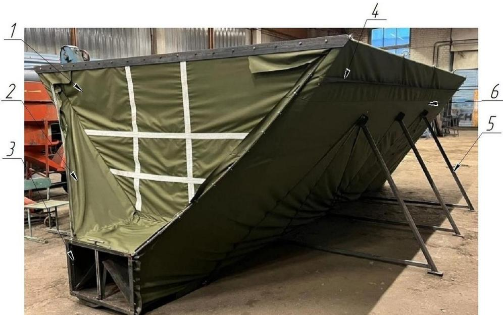
Рисунок 3.3 – Внешняя оболочка камеры сушки: 1 – соединительная часть внутренней оболочки; 2 – воздушный карман; 3 – распределитель с заслонками; 4 – крепление зонта к оболочке; 5 – боковые упоры; 6 – внешняя оболочка камеры сушки
