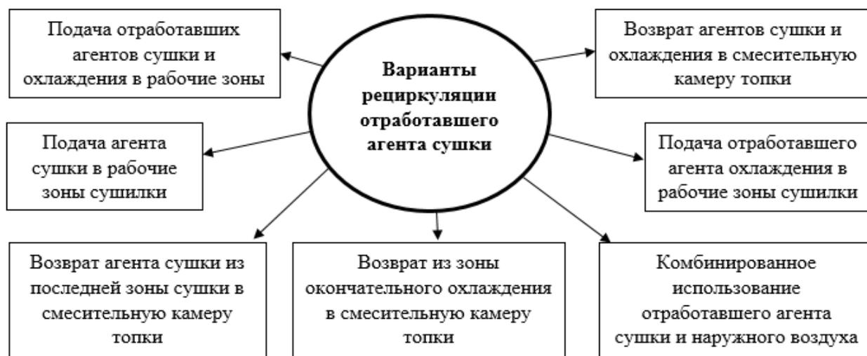
Рисунок 1.4 – Варианты рециркуляции отработавшего агента сушки
