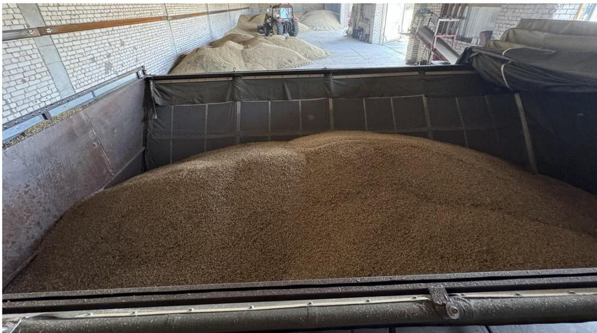
Рисунок 4.8 – Загрузка камеры сушки аэродинамического устройства для сушки зерна яровым ячменем
