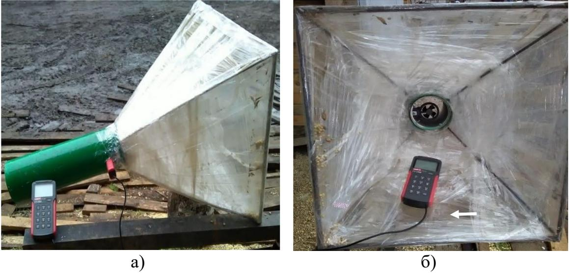
Рисунок 3.6 – Измерительные приборы: электронный анемометр UNI-T UT362 с конфузуром, основание пирамиды 500\*500 мм и высотой 500 мм, диаметр воздуховода 120 мм длина 400 мм, а – вид сбоку; б – вид снизу
