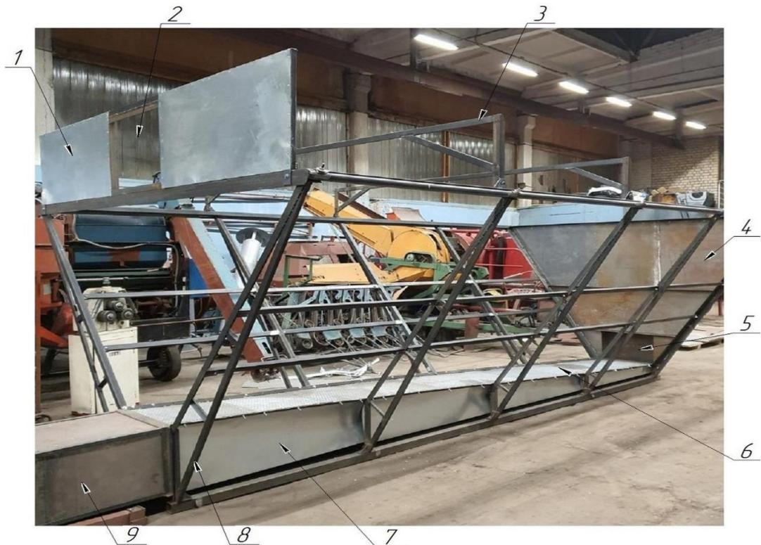
Рисунок 3.1 – Каркас аэродинамического устройства: 1 – неподвижная секция сдвижного зонта; 2 – окно пылеуловителя; 3 – звено сдвижного зонта; 4 – секция камеры сушки; 5 – выгрузное окно; 6 – грузонесущая перегородка; 7 – короб аэро-желоба; 8 – каркас камеры сушки; 9 – распределитель с заслонками
