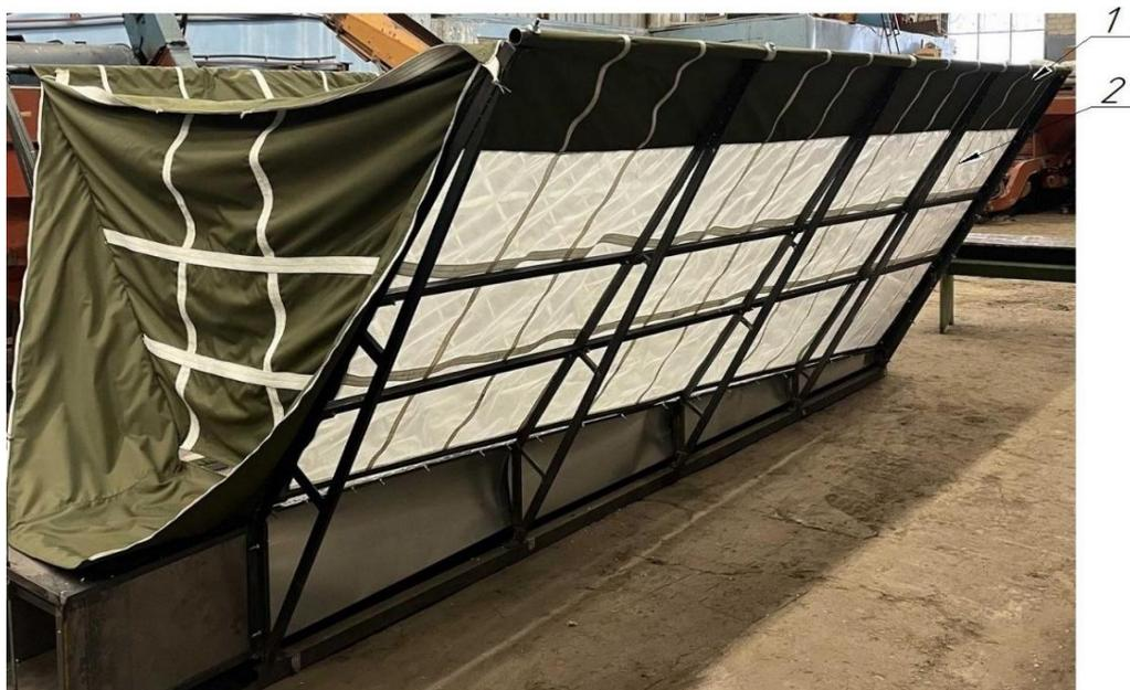
Рисунок 3.2 – Внутренняя оболочка камеры сушки: 1 – пояс из воздухо- и водоотталкивающей ткани; 2 – тканевое сито
