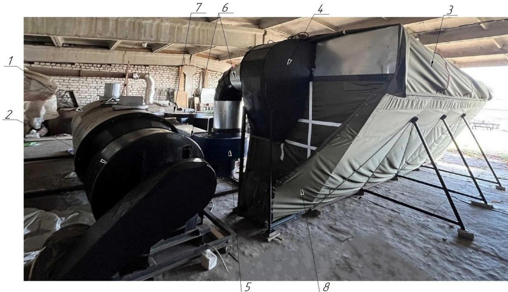
Рисунок 3.4 – Опытный образец аэродинамического устройства для сушки зерна на опытном поле: 1 – теплогенератор; 2 – вентилятор для подачи агента сушки; 3 – оболочка сдвижного зонта; 4 – пылеуловитель; 5 – вентилятор аспиратор; 6 – воздушные патрубки; 7 – клапан-смеситель; 8 – боковой воздухоподводящий короб
