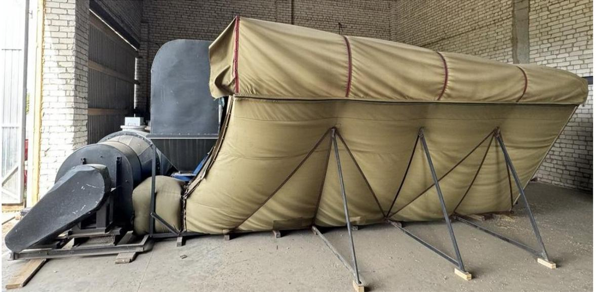
Рисунок 4.6 – Сборка блоков аэродинамического устройства для сушки зерна в ЗАО «Шунга» Костромской области
