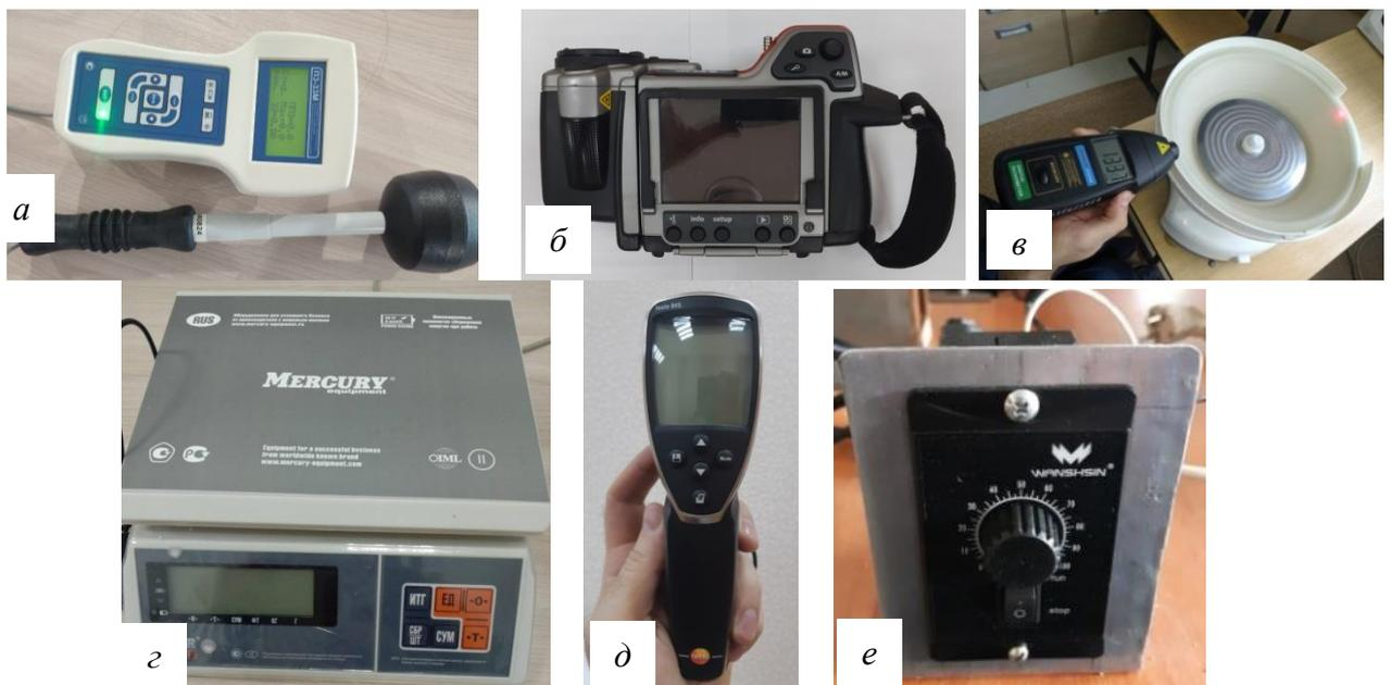
Рисунок 3.1 – Измерительные приборы: а – измеритель плотности потока ЭМП ПЗ-33-М; б – тепловизор FLIR T335; в – фототахометр DT-2234В; г – электронные весы M-ER 326 AFU; д – измеритель температуры Testo 845; е – преобразователь частоты WANSHSIN 0,2 кВт
