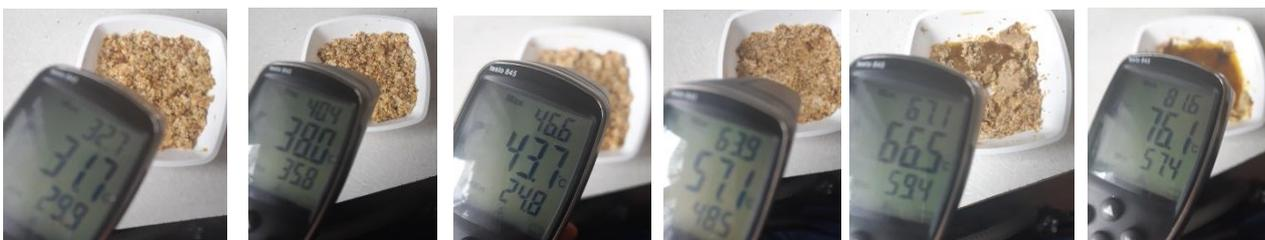
Рисунок Г4 – Хронометраж нагрева забруса с содержанием меда менее 3 % при удельной мощности 1,15 Вт/г
