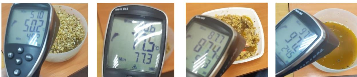
Рисунок Г6 – Хронометраж нагрева забруса с содержанием меда менее 3 % при удельной мощности 1,7 Вт/г
