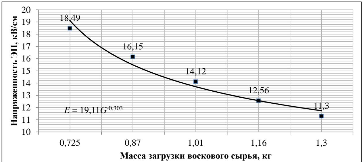
Рисунок 2.4 – Зависимость напряженности ЭП от массы загрузки воскового сырь в резонатор объемом 0,06 м<sup>3</sup> при мощности генератора 1700 Вт
