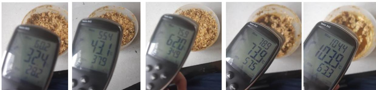
Рисунок Г5 – Хронометраж нагрева забруса с содержанием меда менее 3 % при удельной мощности 1,45 Вт/г
