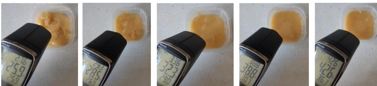
Рисунок Г7 – Хронометраж нагрева закристаллизованного меда при удельной мощности 0,75 Вт/г
