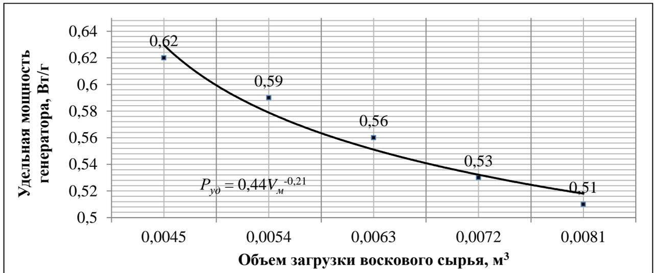
Рисунок 2.3 – Зависимость удельной мощности генератора от объема загрузки воскового сырья в резонатор объемом  $0,06 \text{ м}^3$  при мощности генератора  $1700 \text{ Вт}$
