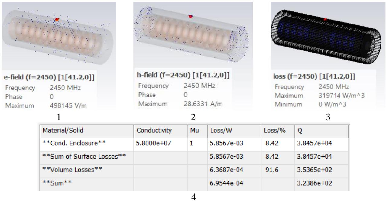
Рисунок 2.25 – ЭД-параметры первого нагруженного цилиндрического резонатора, полученные в программе CST Microwave Studio:
