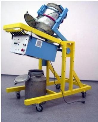
Рисунок 1.14 – СВЧ-установка для разжижения меда УРМ-4
