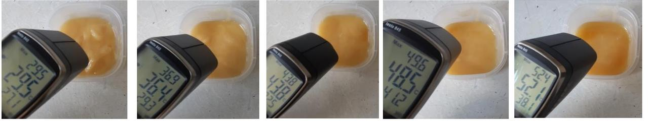
Рисунок Г9 – Хронометраж нагрева закристаллизованного меда при удельной мощности 1,05 Вт/г
