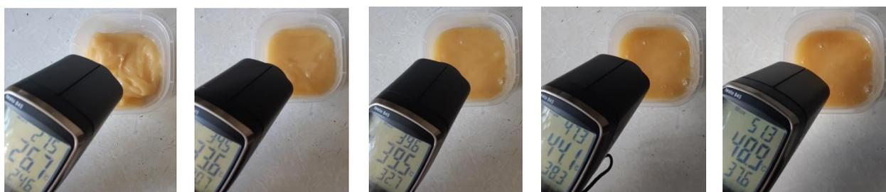
Рисунок Г8 – Хронометраж нагрева закристаллизованного меда при удельной мощности 0,9 Вт/г
