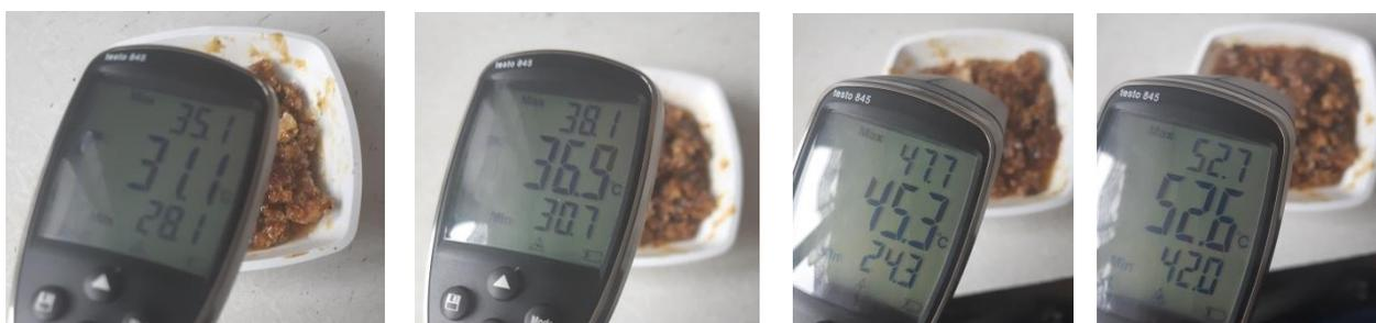
Рисунок Г2 – Хронометраж нагрева забруса с содержанием меда 7–10 % при удельной мощности 0,75 Вт/г
