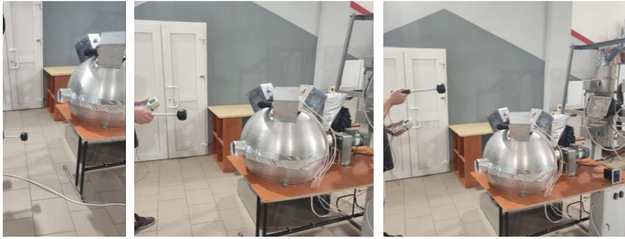
Рисунок 4.16 – Измерение плотности потока энергии ЭМП
