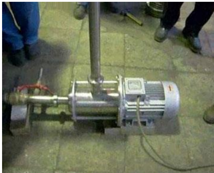
Рисунок 1.6 – Напорная система гомогенизатора
