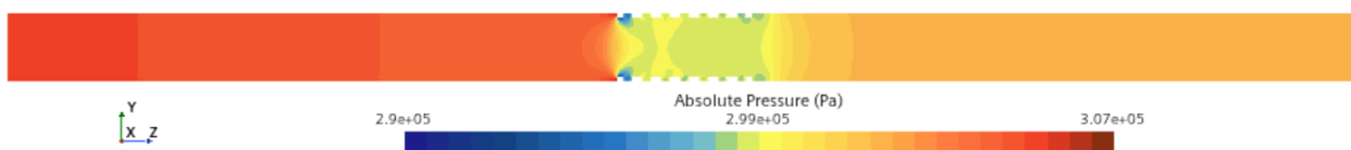
Рисунок 2.20 – Поля абсолютного давления в трубе с решеткой длиной 100 мм
