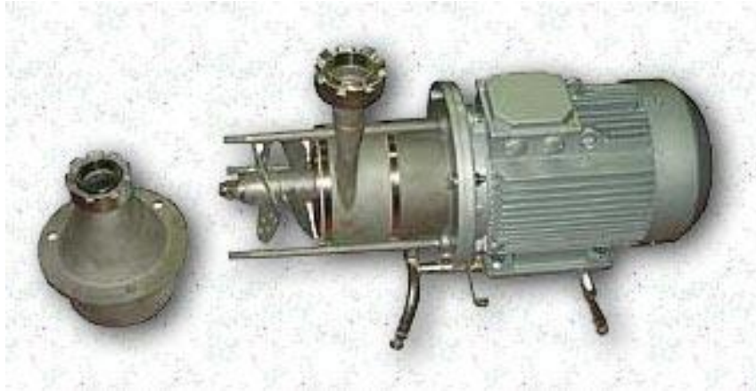
Рисунок 1.5 – Наклонные перфорированные плоскости в виде вращающегося шнека
