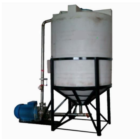
Рисунок 1.20 – Установка приготовления патоки УЗП-1.
