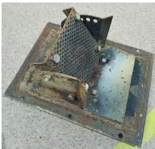
Рисунок 3.4 – Дополнительная решетка пассивного измельчителя (решето)
