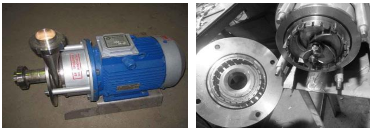
Рисунок 1.8 – Конструкция гомогенизатора в сборе с двигателем
