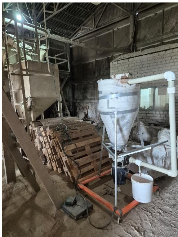
Рисунок 4.19 – Установка приготовления зерновой патоки в цехе
