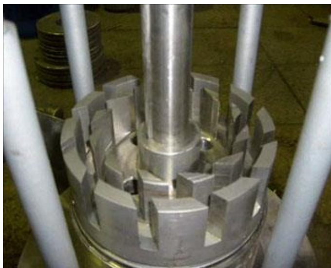
Рисунок 1.4 – Конструктивная суть гомогенизатора
