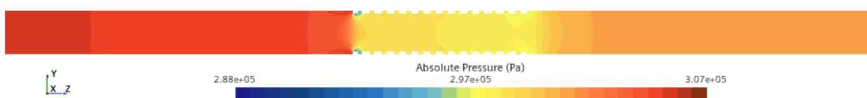
Рисунок 2.21 – Поля абсолютного давления в трубе с решеткой длиной 200 мм
