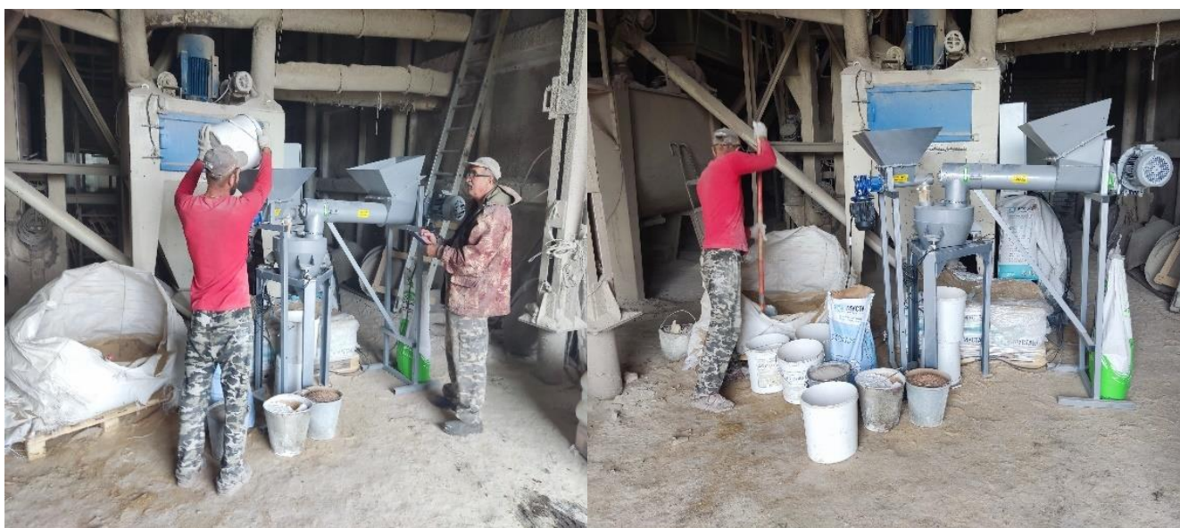
Рисунок 3.10 – Двухшнековый дозатор сухих сыпучих компонентов комбикорма
