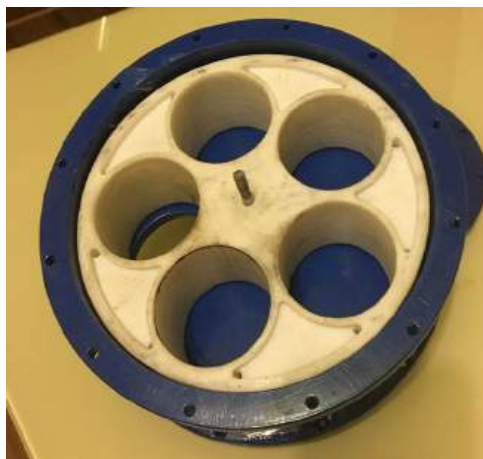
Рисунок 3.3 – Внешний вид барабана-питателя устройства подачи механических очистителей*
