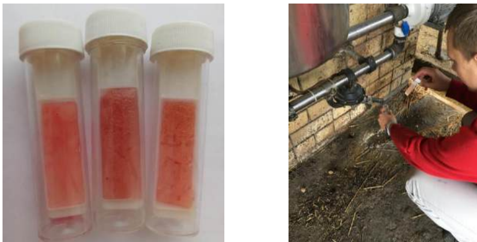
Рисунок 4.11 – Пример проб с использованием микробиологического экспресс-теста «Биоконтроль»*
