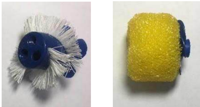
Рисунок 3.1 – Общий вид изготовленных механических очистителей с чистящей поверхностью из щетины и поролона *
