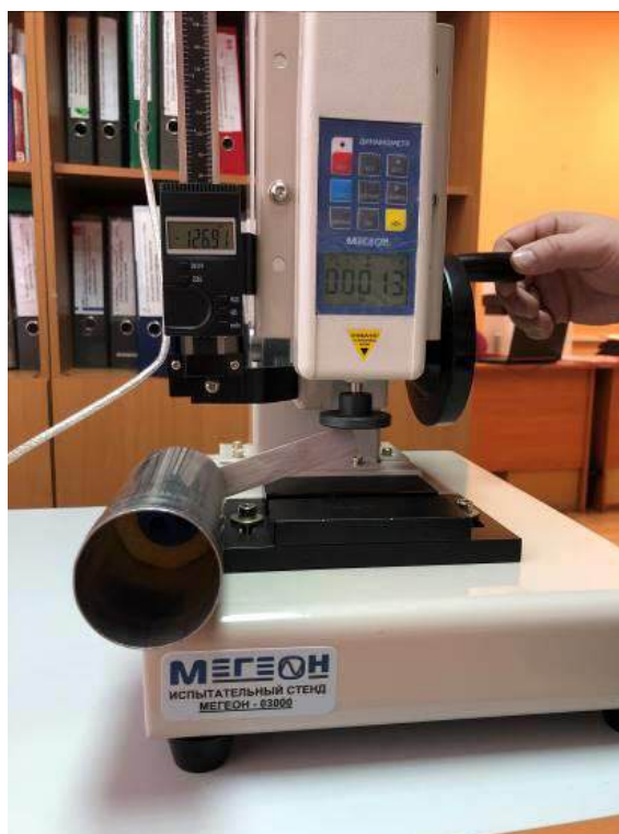
Рисунок 4.9 – Определение силы давления механического очистителя на стенку молокопровода, возникающей вследствие его вращения*
