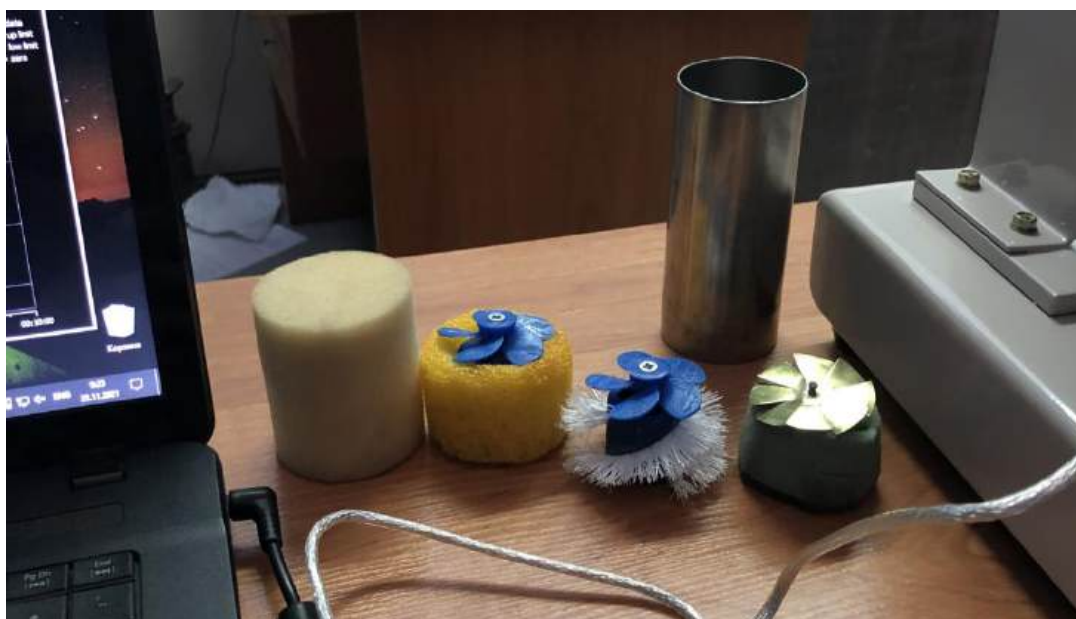
Рисунок 3.7 – Общий вид механических очистителей, используемых при определении силы трения*
