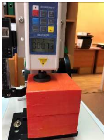
Рисунок 4.8 – Пример проведения исследований силы давления механического очистителя на стенку молокопровода*
