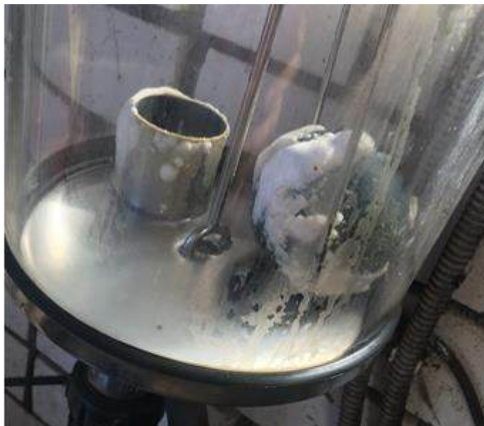
Рисунок 1.3 – Молочный камень на рабочей поверхности доильного оборудования
