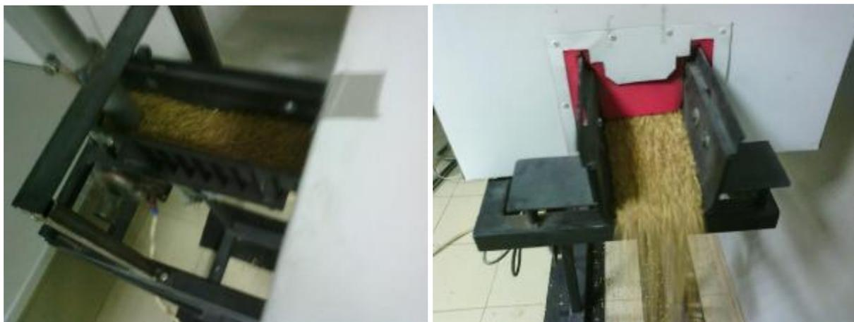
Рисунок 5.1 – СВЧ-обработки семян ячменя в производственных условиях
