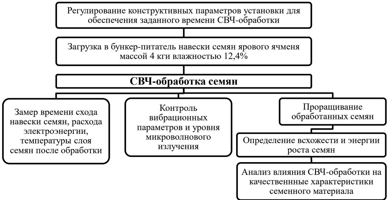
Рисунок 3.18 – Алгоритм процесса СВЧ-обработки семян зерновых культур
