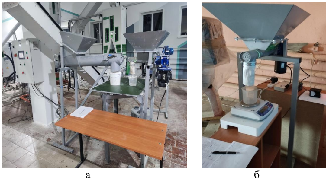
Рисунок 7 – Общий вид лабораторных установок: а – двухшнековый дозатор с асинхронными электродвигателями; б – шнек точной досыпки с шаговым электродвигателем
