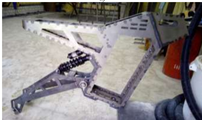
Рисунок 3 – Рама самодельного электровелосипеда:
