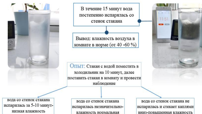
Рисунок 9 – Определение влажности воздуха без специального оборудования
