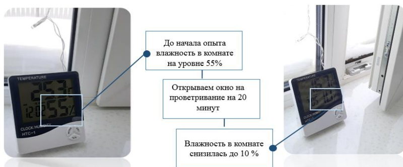
Рисунок 7 – Опыт «Можно ли повысить влажность воздуха в комнате с помощью проветривания?»
