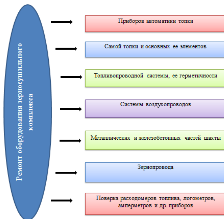
Рисунок 3 – Ремонт оборудования зерносушильного комплекса
