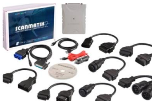
Рисунок 2 – Диагностическое оборудование Scanmatik 2 pro
