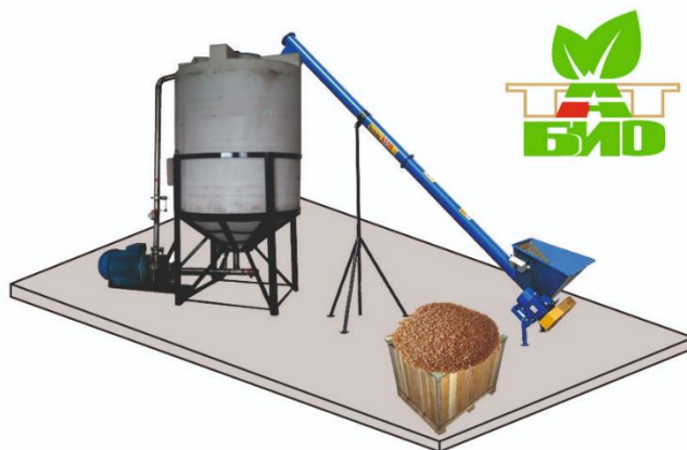
Рисунок 4 – Общий вид технологической установки по приготовлению зерновой патоки
