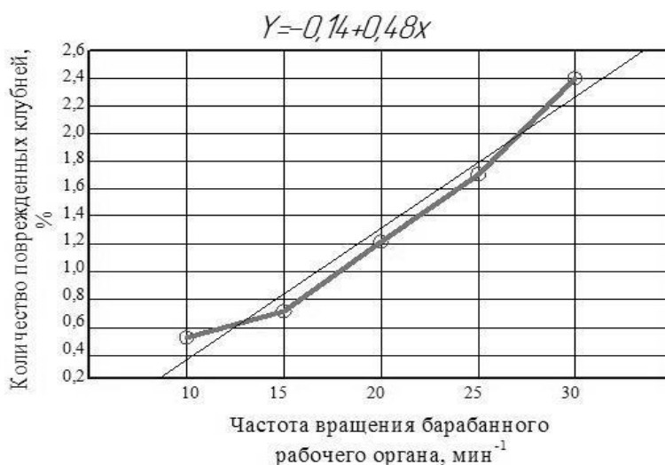
Рисунок 2 – Зависимость количества поврежденных клубней в % от частоты вращения барабана
