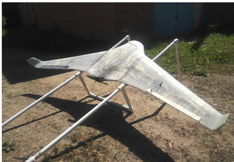
Рисунок 1 – Модель спроектированного летающего крыла
