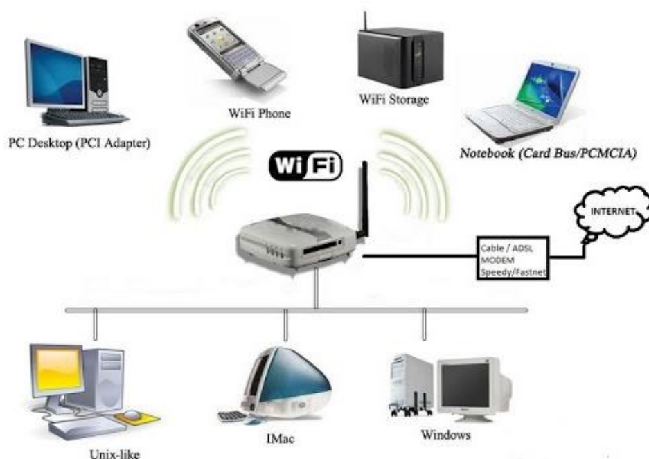
Рисунок 1– Общая архитектура Wi-Fi сетей
