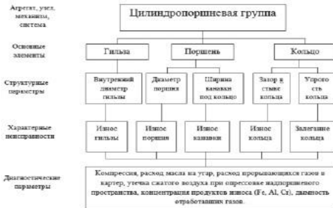
Рисунок 1 – Схема ЦПГ двигателя внутреннего сгорания как объекта диагностирования
